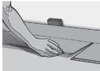
Mit dem Reststück der ersten Reihe wird in der nächsten Reihe wieder begonnen (stirnseitiger Versatz von mindestens 1/3 der Elementlänge, bei Landhausdielen XL mindestens 50cm). Dadurch wird der Verschnitt erheblich reduziert. Die weitere Verlegung erfolgt elementweise. Dazu werden die Elemente zuerst längsseitig mit leichtem Druck in die Verbindung eingedreht.
